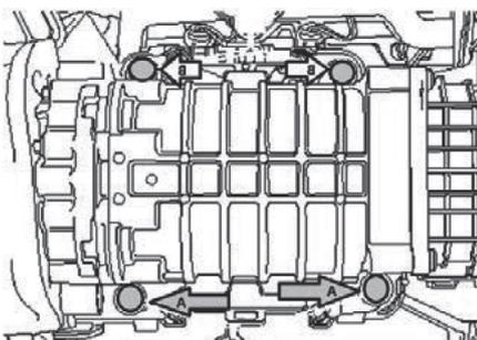
Parte C - Nos modelos equipados com um turbocompressor, utilizar os pinos (C) em vez do pino (A) para ajudar a orientar o compressor para cima e para baixo.
