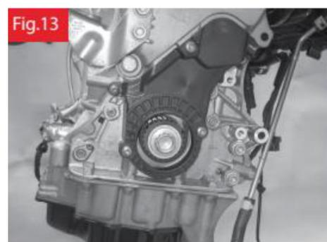
1.3.7. Retire a polia da cambota e o parafuso da roda dentada central (fig. 13).
