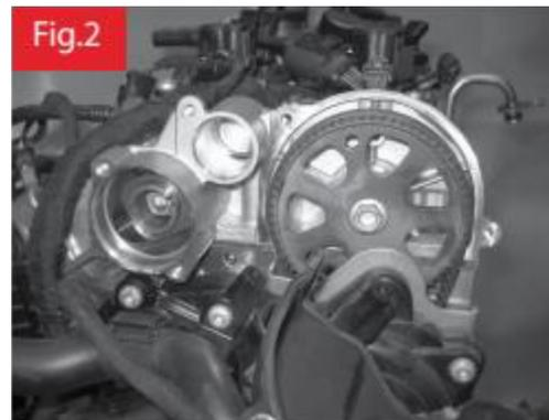
1.1.5. Retire a tampa da correia de distribuição da bomba de arrefecimento do motor (fig. 2).
