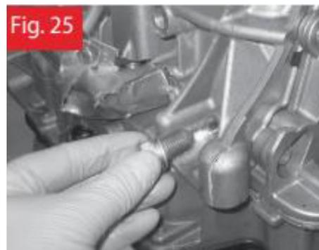
Volte a colocar o suporte de montagem do motor em alumínio.
