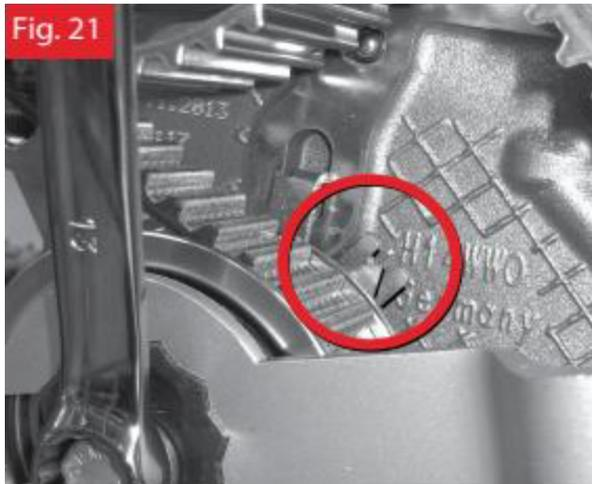
Rode o mandril no sentido contrário ao dos ponteiros do relógio até que o ponteiro esteja alinhado com a ranhura no indicador (fig. 21). Segure o tensor na posição e aperte o parafuso de bloqueio do tensor a 25 Nm.
