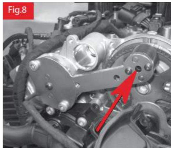
1.1.17. Colocar a placa de regulação da árvore de cames na ranhura de regulação na parte de trás da árvore de cames de escape (fig. 8).
