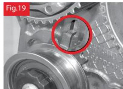
5.3.22 Substitua a polia e a polia da correia de distribuição. Aperte o parafuso de fixação da polia guia com 45 Nm.
