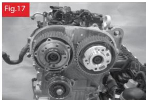
1.3.15. Certifique-se de que a cavilha de bloqueio da cambota está no lugar (fig. 5) e de que a cambota ainda está na posição correcta.
