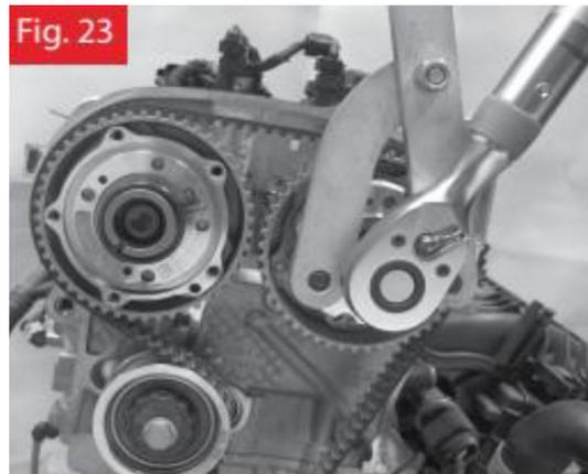
1.3.26. Utilizando uma ferramenta de fixação do medidor adequada, tal como a ferramenta de fixação do pinhão da árvore de cames, aperte os parafusos do pinhão central da árvore de cames a 50 Nm (figs. 22 e 23).
