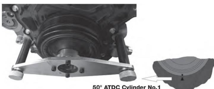
**D Ferramenta bloqueio e desmontagem:**
