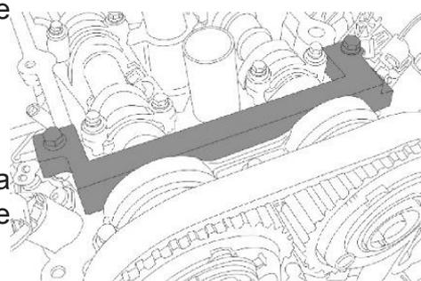
Ferramenta de bloqueio do volante do motor (2) utilizada para bloquear a cambota durante o desaperto e a fixação da polia da cambota e deve ser utilizada como OEM 303-1643.
