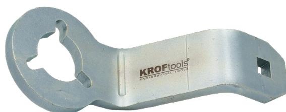
Desenvolvido para permitir ao utilizador segurar o suporte da polia da cambota dianteira enquanto desaperta o parafuso de fixação central para substituição da correia de distribuição e desmontagem do motor. Especialmente concebido para permitir a utilização em cubos de polia com 3 e 6 parafusos de fixação.
