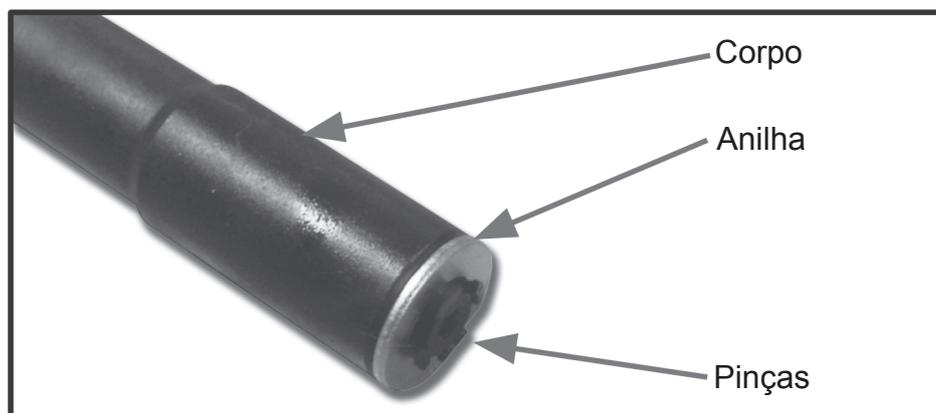
3. Remova a anilha retirada para ajustar as pinças do extrator e insira o extrator, coloque as pinças no tubo do injetor.
