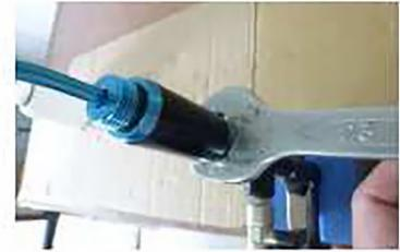
3. Desaperte-o com uma chave de 23MM
