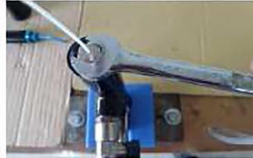
5. Desaperte a porca do tubo de Teflon com uma chave 10MM
