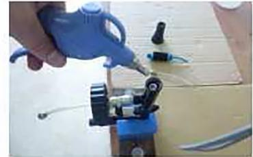
6. Limpe a sujidade para evitar que o tubo de Teflon fique bloqueado
