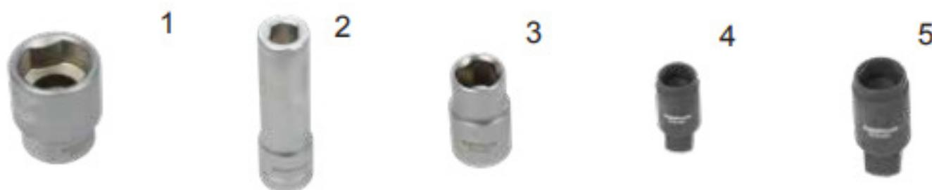
**Aplicação:** As chaves de caixa especiais são necessárias para desapertar e remover os parafusos com cabeças triangulares da bomba de injeção.
