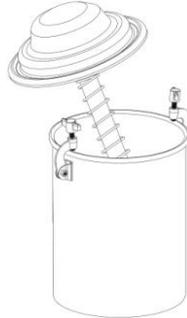
3. A capacidade máxima do depósito para lubrificação é de 13 kg. Encha o depósito com a quantidade necessária de massa espessa. Não permita a formação de bolhas de ar na massa que enche o depósito. Para o efeito, pressione a massa e nivele a superfície da massa.
