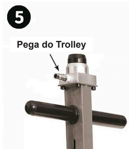
5. Ligue bem a fonte de ar ao levantar. A bomba de ar tem mais de 0,6 metros cúbicos e o diâmetro do tubo deve ser superior a 8.
