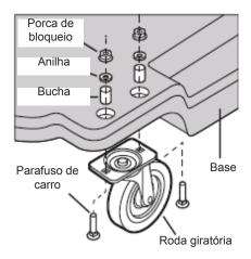
Figura 2 - Montagem geral de roda simples
