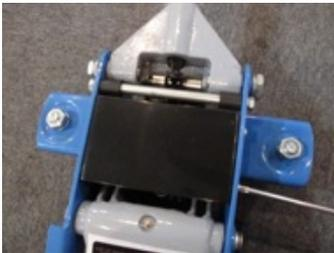
Desapertar o parafuso de fixação
