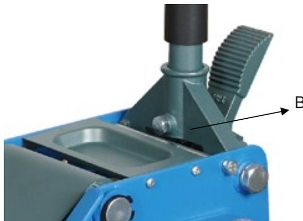
3.2.6 Certifique-se de que o punho está corretamente inserido na tomada e, em seguida, aperte o parafuso da tomada do punho (B). Certifique-se de que a pega pode ser rodada sem problemas.
