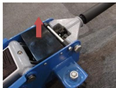
6.3.3 Com o macaco na posição nivelada, retire o bujão de enchimento de óleo.
