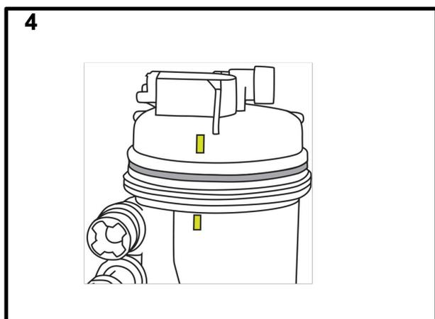
Substitua os vedantes de borracha de ambas as partes, fornecidos com o novo filtro. Volte a montar ambas as partes alinhando estas pelas marcas amarelas. Retire a parte superior da parte do filtro de combustível, tenham em atenção para não tocar no filtro de papel.
