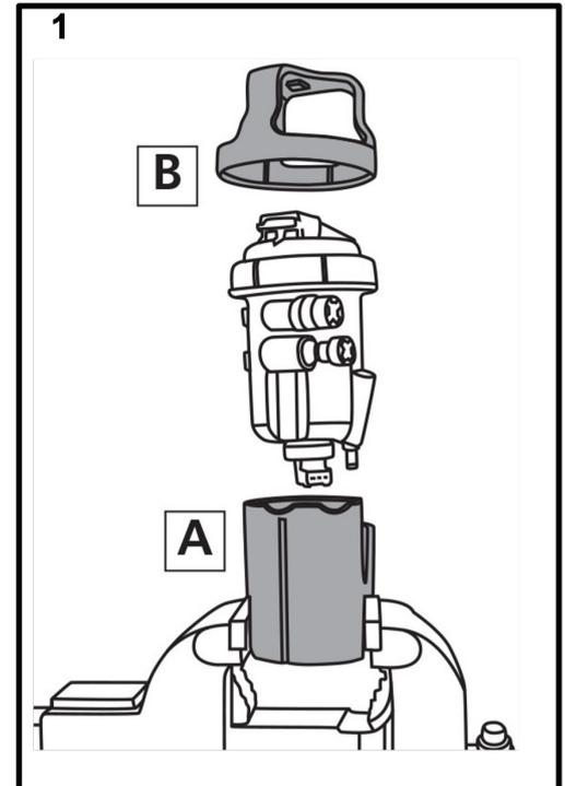
Antes de colocar o filtro de combustível, veja que todos os fios elétricos e outras ligações estão desligado depois coloque a peça A e B de acordo com as ranhuras. Usando um roquete de 1/2" rode a peça B no sentido contrário dos ponteiros do relógio.
