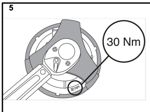
Aperte a tampa de fixação em 30Nm de aperto. Seguidamente volte a colocar o filtro no veículo e ligue novamente todas as ligações. Verifique que não existem fugas. Nota: O filtro é de "sangramento automático".
