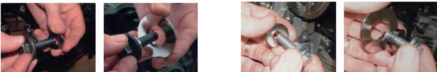
Escolher um comprimento e um número adequados de mangas de compensação (1) (se necessário) e uma manga de montagem adequada (2).
