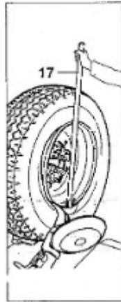
**Fig.7.6****Levar a unidade móvel de controlo para a posição de trabalho B.**
