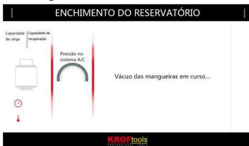
F) Abrir a válvula do reservatório de origem. Clique
