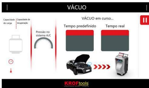
5) Se optar pela verificação de fugas, o programa de aspiração passará para o programa de verificação de fugas. O sistema irá solicitar o tempo de verificação de fugas referível. Se não for necessário efetuar a verificação de fugas, clique em “Saltar” para passar ao passo seguinte.
