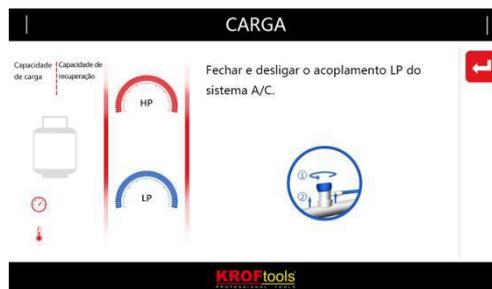
11) Certificar-se de que o acoplamento HP&LP foi fechado e desligado, clicar
