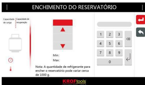
D) Ligar a mangueira vermelha ao reservatório de origem, certificar-se de que a válvula do reservatório de origem foi fechada. Clique
