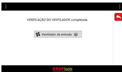
**Nota:** O equipamento possui medidas de proteção de segurança, tais como a deteção automática do ventilador quando este é ligado. Se o ventilador deixar de funcionar, o equipamento emite automaticamente um aviso.
