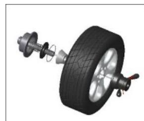
Eixo principal - cone adequado (cabeça grande para dentro) - roda - porca de pega rápida
