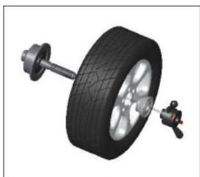
Eixo principal - cone adaptável à roda (cabeça pequena para dentro) - porca de pega rápida
