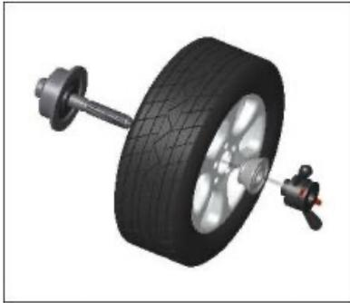
Eixo principal - cone adaptável à roda (cabeça pequena para dentro) - porca de pega rápida
