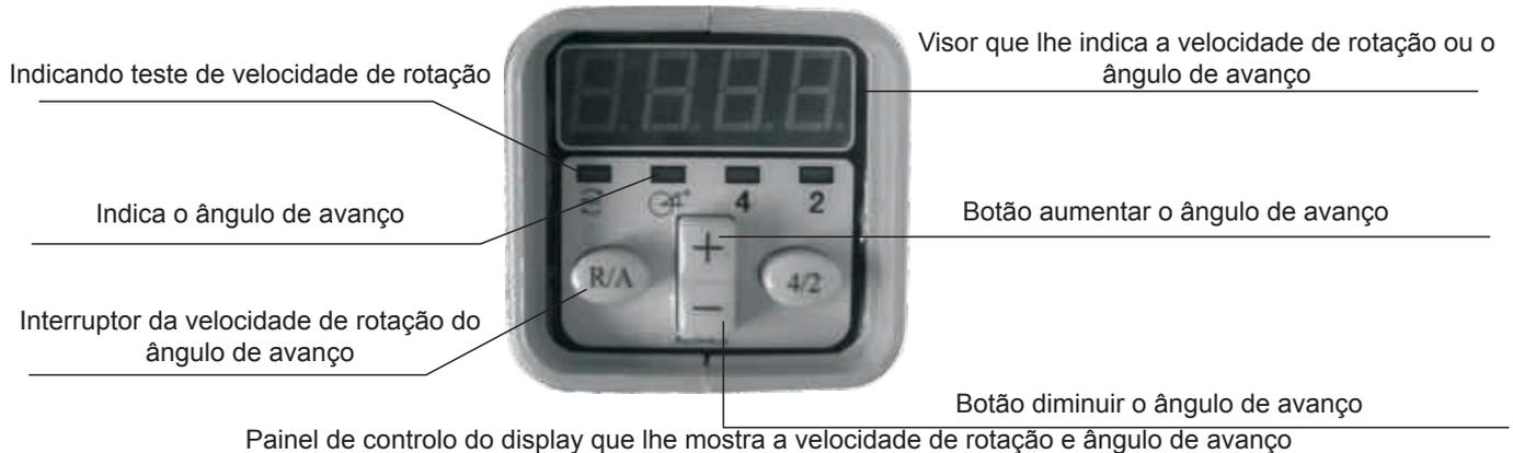
7.4- Compare os graus exibidos com os graus especificados pelo fabricante. Se o tempo de ignição não mudar quando se verifica o controlo de avanço da ignição mecânica / centrífuga, o bloco de sistema pode estar enferrujado ou preso.
