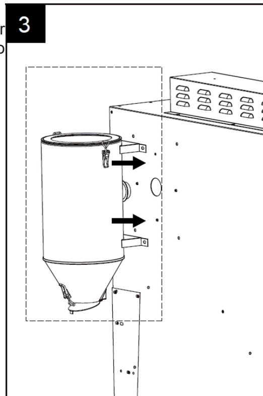
**Passo 4: Colocar a Parte Um na Parte Dois. O fecho da porta está alinhado com o fecho da porta.**
