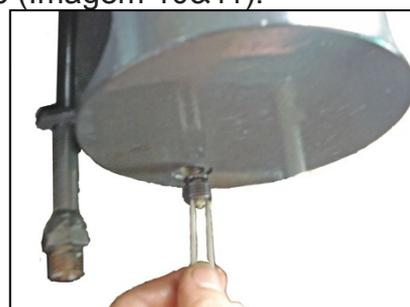
Figura 9 (Válvula anti bloqueio)
