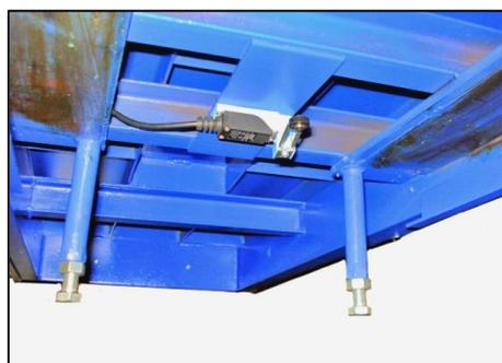
Figura 26 (interruptor de limite inferior)
