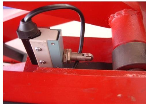
Figura 25 (interruptor de limite de subida do segundo elevador)
