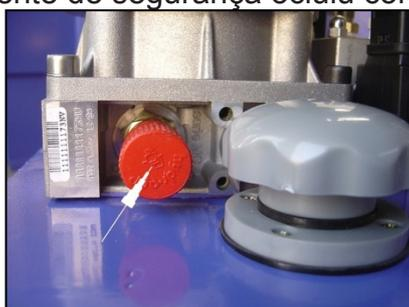
Figura 8 (Válvula de excesso)
