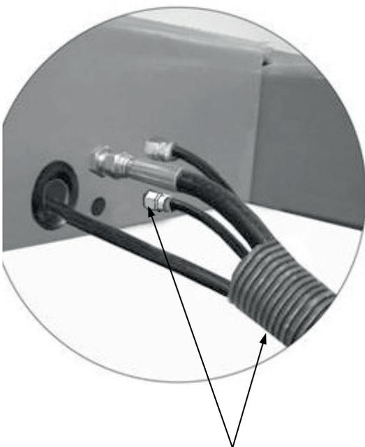
c Apertar a mangueira de óleo do kit de linha de ar, a mangueira de óleo e a linha de ar do sistema de linha de ar do elevador através de kits de atar e passá-los através da mangueira plástica protectora
