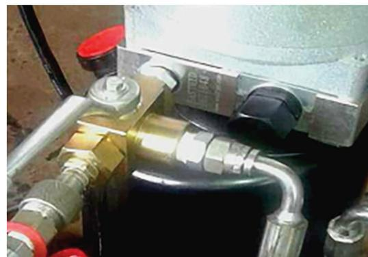
3. Utiliza a bomba manual para elevar a máquina entre 2 a 4 cm.
