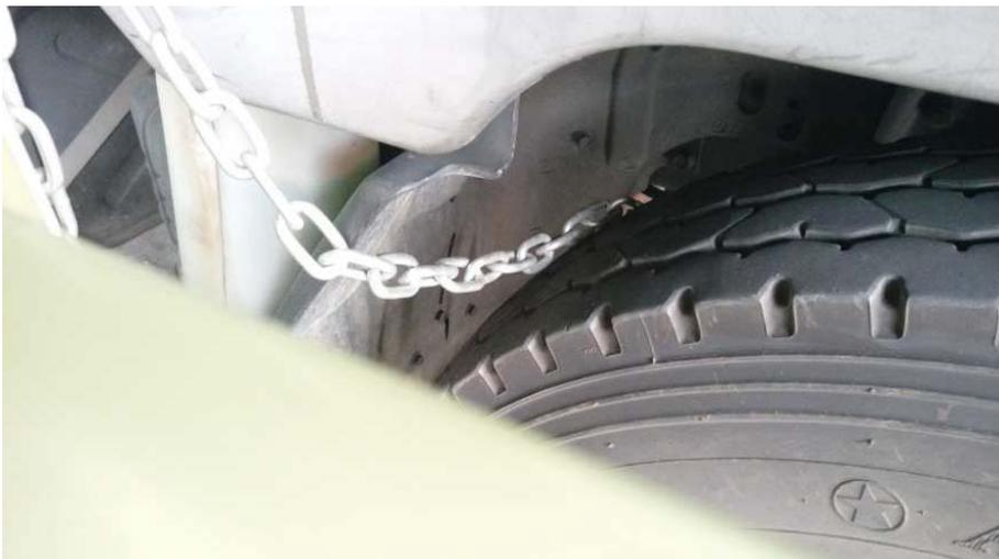
**Passo 9. Puxar o AE200003 para instalar / desinstalar o pneu (Imagem 10).**
