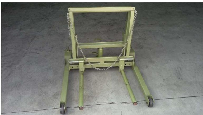
**Passo 2. Para ajustar a largura do AE200003, por favor ajustar a largura do elevador de rodas e instalar o pino de fixação num dos orifícios de fixação para definir a largura (Imagens 2 e 3).**
