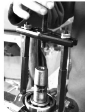
O rolamento é então extraído do veio. Quando retirar o parafuso central da barra, deverá ter cuidado para não danificar as roscas. Deverá levantar a partir das extremidades do parafuso central. Colocar novamente as peças na caixa para um armazenamento ideal.
