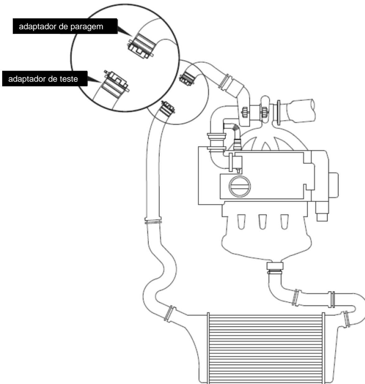
3) Pressurizar o sistema para detetar a fuga.
