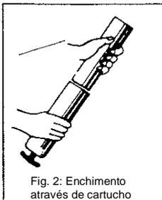
Fig. 2: Enchimento através de cartucho
