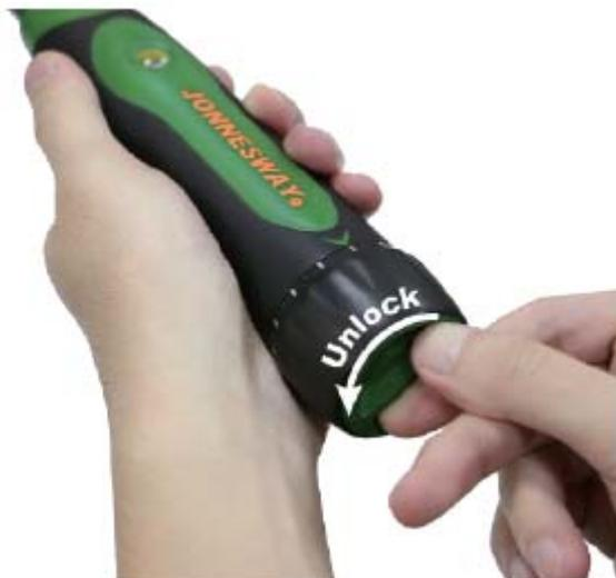
2. Assim que o **bloqueio de segurança** esteja desbloqueado, rodar o **anel de ajuste do aperto** até o **visor** mostrar a configuração pretendida do aperto. Rodar depois o bloqueio de segurança para a direita para bloquear a configuração.
