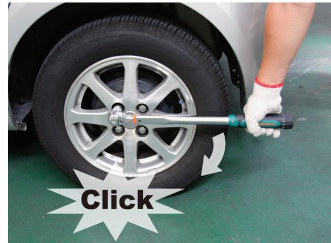
*Atenção: Quando configurada no aperto inferior, é fácil atingir o aperto de configuração; assim, recomenda-se efetuar um pré teste ao "resultado do click" na configuração de aperto inferior antes da utilização para evitar possíveis danos devido ao aperto excessivo do parafuso.*
