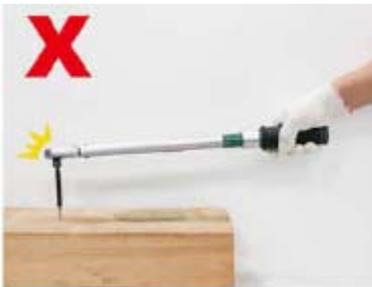
**Não utilizar a chave dinamométrica como um martelo**
