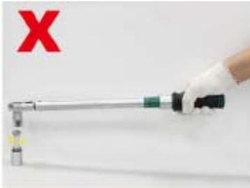
**Não utilizar a chave dinamométrica para desapertar parafusos**
