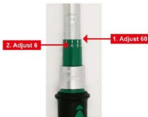
4. **Bloquear:** Após configurar o aperto pretendido, empurrar o punho para afrente para bloquear.
