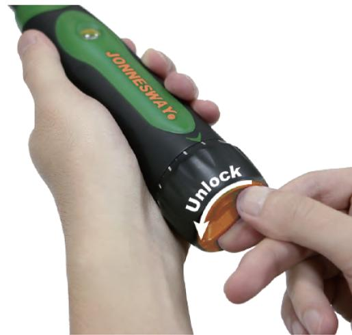
2. Assim que o **fecho de segurança** esteja desbloqueado, rodar o **anel de ajuste do aperto** até o **visor** mostrar a configuração pretendida do aperto. Rodar depois o fecho de segurança para a direita para bloquear a configuração.
