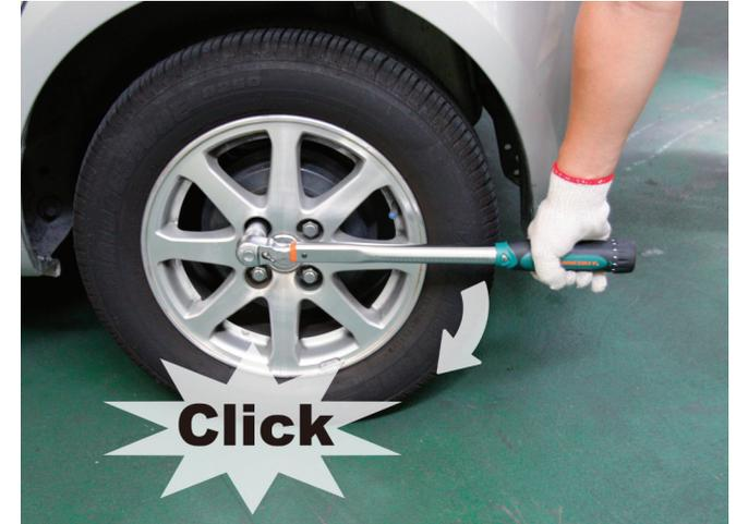
*Atenção: Quando configurada no aperto inferior, é fácil atingir o aperto de configuração; assim, recomenda-se efetuar um pré teste ao "resultado do click" na configuração de aperto inferior antes da utilização para evitar possíveis danos devido ao aperto excessivo do parafuso .*
