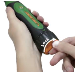
*Atenção: Quando rodar o **anel de ajuste do aperto**, NÃO exceder o aperto máximo, caso contrário, o mecanismo interno ficará gravemente danificado.*
