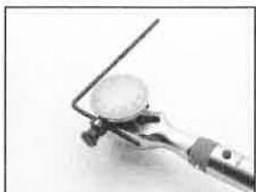
Montagem do medidor angular de torque
